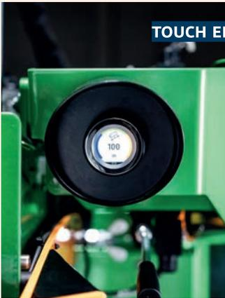
Die moderne Bedieneinheit mit hochauflösendem Display ermöglicht eine smarte Kommunikation mit Ferdinand: Anzeige der Tages- und Gesamtstunden, Öltemperatur, Zapfwellendrehzahl, des Spaltdrucks sowie die Möglichkeit, die Arbeitsbeleuchtung ein- oder auszuschalten.
